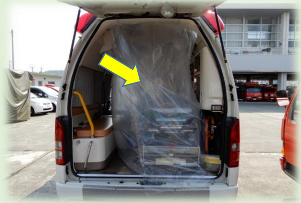
救急患者搬送用ストレッチャー周囲に設置した 養生シート（使用している状態です）
