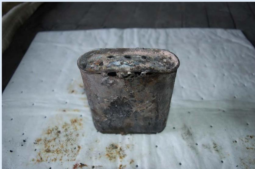
長期間使用した低圧進相コンデンサは、絶縁劣化が進んでいるものが多く、発熱しやすい状態となっています。高温・多湿という悪条件が重なり、膨張し破裂、内部でガス化した絶縁油が噴出し出火します。
